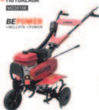
Motoazada de 7CV. Sistema de transmisión de cadena + correa. Tiene 3 velocidades: -1, 0, 1, 2. Sus 6 grupos de fresas modulares, permiten conseguir 3 anchuras de trabajo: 450-650-850 mm. Profundidad de trabajo: 150-300 mm.
